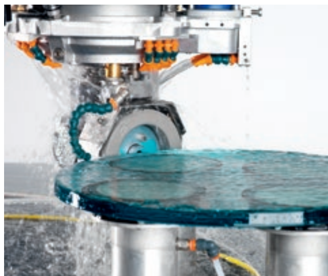
集成头杯形加工研磨成型。
